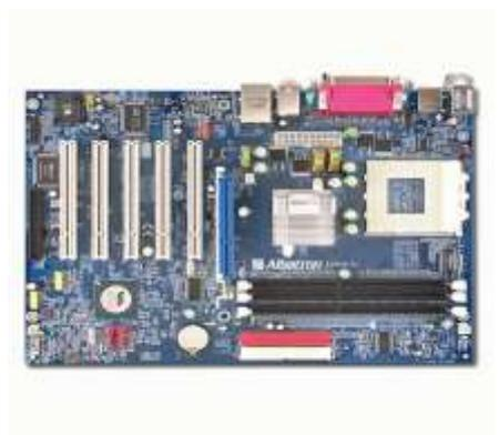
чипсетом (от англ. chipset). Чипсет - это совокупность микросхем, обеспечивающих согласованную совместную работу составных частей компьютера и их взаимодействие между собой. Как правило, чипсет состоит из двух основных микросхем, чаще всего называемых "северным" и "южным" мостами.
