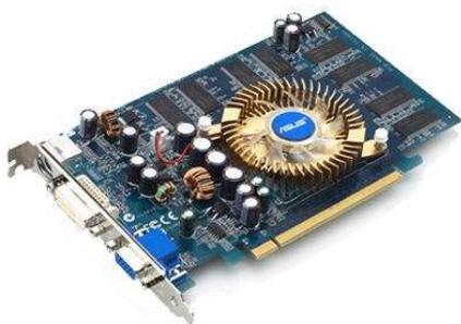
*Видеокарта* – (графическая плата, видеоадаптер) (videocard, VideoBlaster) — устройство, преобразующее изображение, находящееся в памяти компьютера, в видеосигнал для монитора.
